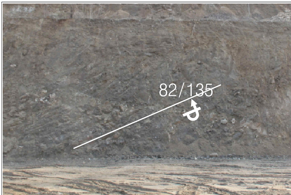
【그림 13】 A 영역에 발달한 불연속면
